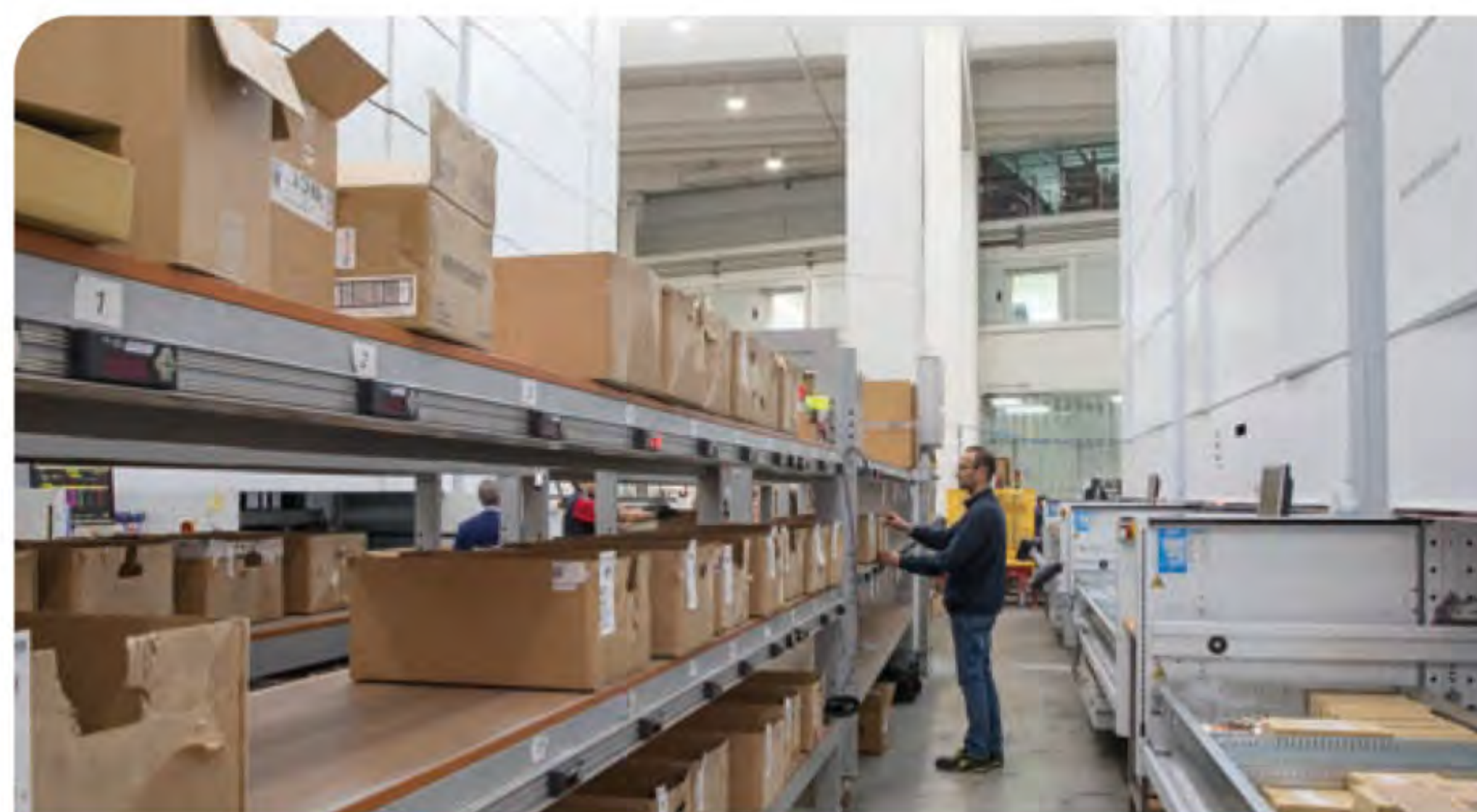
Sistemas Put to Light conectados al WMS
